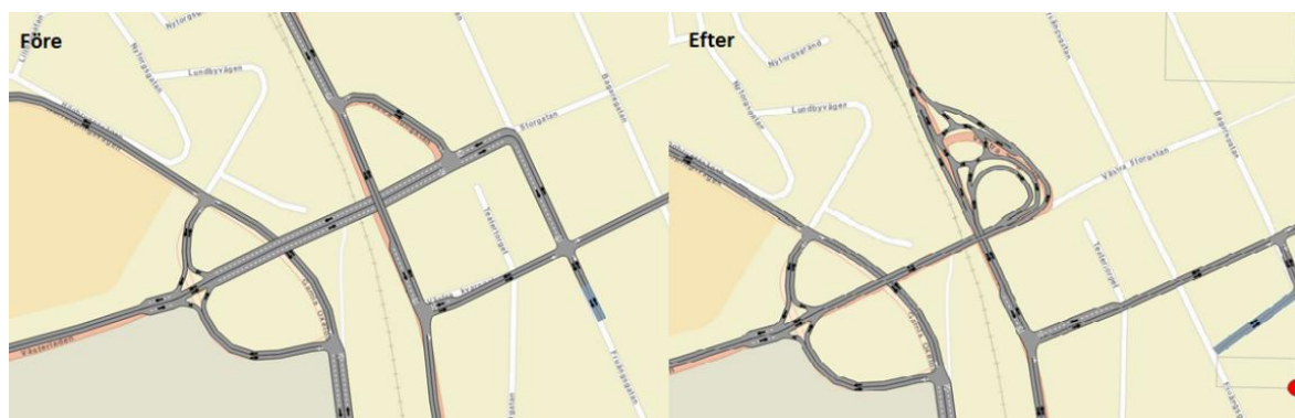
Figur 19. Utformning av Västra Viadukten. Till vänster innan ombyggnation, till höger efter ombyggnation.
