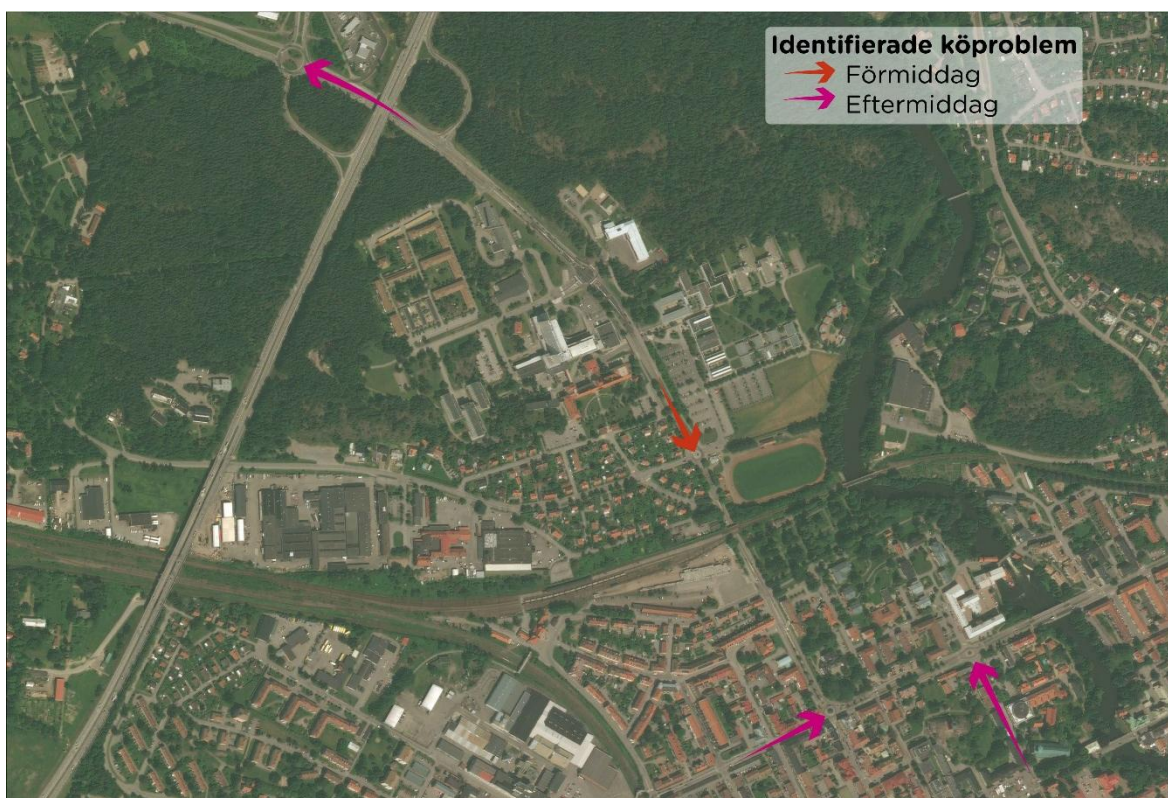
Figur 27. Platser där köbildning identifierats i simuleringarna. Pilens längd motsvarar simulerad medelkölängd.
