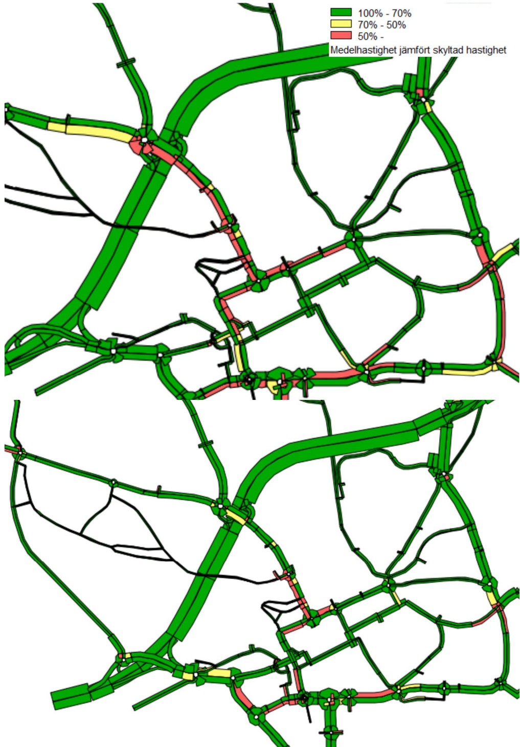
Figur 55. Simulerad hastighetnedsättning, medelhastighet jämfört med skyltad hastighet under eftermiddagens maxtimme 2030 med (nederst) och utan (överst) Kungsladugårdsleden. Båda alternativen innehåller en förlängning av Hamnleden (M4Traffic, 2013).
